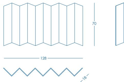
Possibilità di montaggio verticale e orizzontale, su parete piana. I singoli elementi sono accostabili tra loro in orizzontale o in verticale generando figure diverse.
