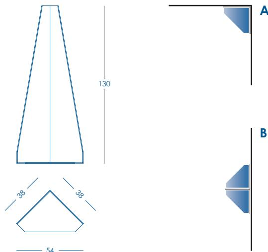
Possibilità di montaggio con mensola in basso oppure con mensola in alto, in angolo retto fra due pareti (**A**) o su parete piana (**B**). I singoli elementi sono accostabili tra loro in orizzontale o in verticale generando figure diverse.
