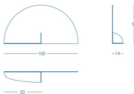
Possibilità di montaggio verticale, orizzontale, con mensola in basso, con mensola in alto, su parete piana(**A**) o in angolo retto fra due pareti(**B**). I singoli elementi sono accostabili tra loro in orizzontale o in verticale generando figure diverse.
